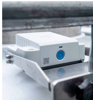
Micropilot FWR30 gemonteerd op een IBC-container
