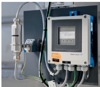
Der WirelessHART-Adapter (links im Bild) kann einfach in Bestandsanlagen nachgerüstet werden.
